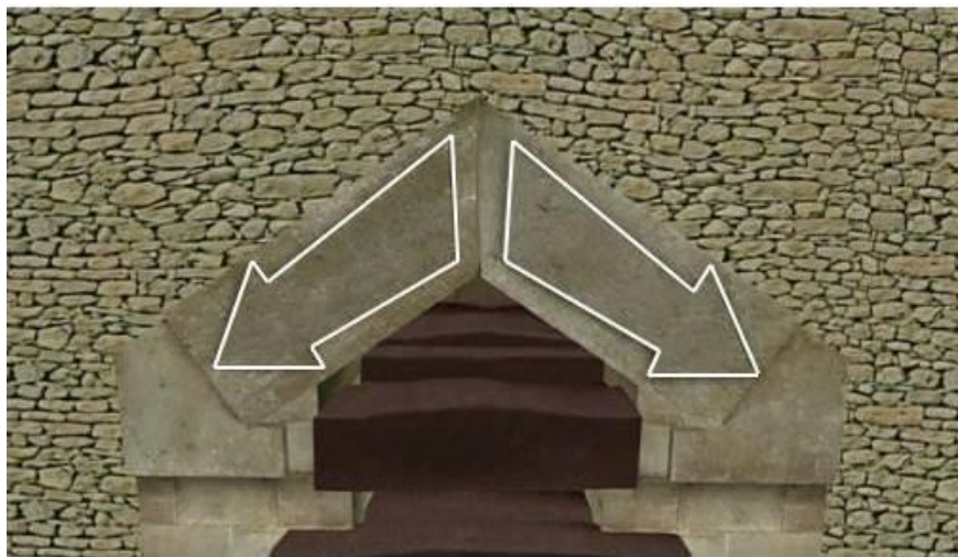
Рис. 3 Двускатное перекрытие над разгрузочными полостями над камерой царя. Эта система снимает нагрузку с потолка нижних камер.
